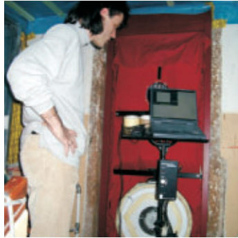
Blower-Door-Test: Bei Unter- / Überdruck wird der Volumenstrom pro Stunde gemessen.
