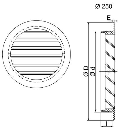
\* Das Gitter hat seitlich im Rahmen 2 x Ø 4,2 mm Bohrungen für die Schraubbefestigung.
