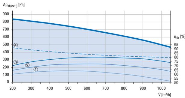
① SFP=1,5 kW/m³s ② SFP=2 kW/m³s ③ SFP=2,5 kW/m³s ④ η<sub>th</sub>
