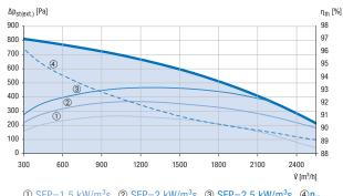
① SFP=1,5 kW/m³s ② SFP=2 kW/m³s ③ SFP=2,5 kW/m³s ④ $\eta_{th}$
