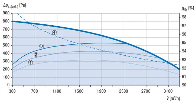
① SFP=1,5 kW/m<sup>3</sup>s   ② SFP=2 kW/m<sup>3</sup>s   ③ SFP=2,5 kW/m<sup>3</sup>s   ④ η<sub>th</sub>
