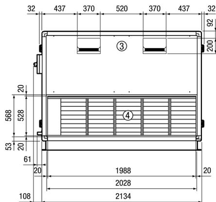
① Zuluft ② Abluft ③ Fortluft ④ Außenluft
