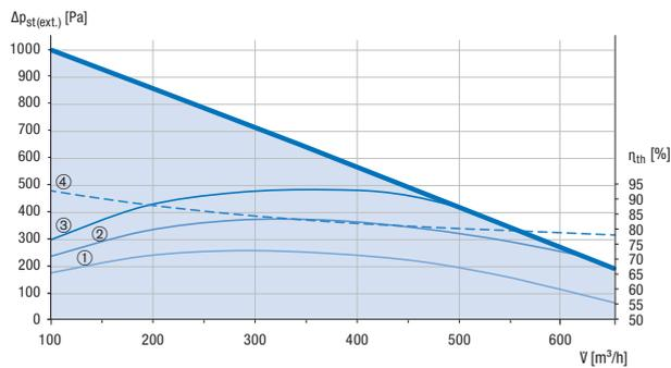
① SFP=1,5 kW/m<sup>3</sup>s   ② SFP=2 kW/m<sup>3</sup>s   ③ SFP=2,5 kW/m<sup>3</sup>s   ④ η<sub>th</sub>
