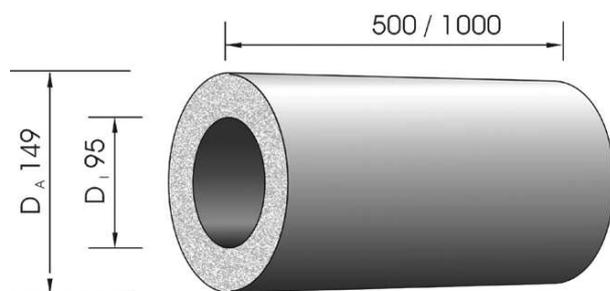
passt in HT-Rohr  $D_1$  150 mm
