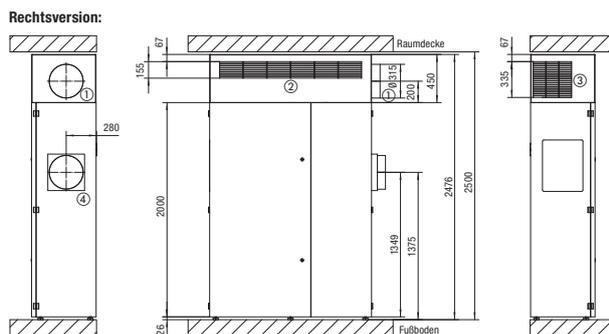
Topbox Standard für geniovent.x 600/900 S BR (Brüstungsvarianten mit seitlichem Außenluftanschluss nach rechts).
