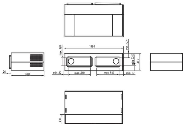
Innerhalb der gelaserten rückseitigen Kontur des Anschlusskastens müssen bauseits die Fensteranschluss-Öffnungen erstellt bzw. ausgeschnitten werden. Die min. Werte bzw. max. Werte müssen dabei eingehalten werden.
