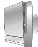
Schallgedämmter Außenwandluftdurchlass mit integrierter Sturmsicherung. Volumenstrom manuell stufenlos einstellbar über integrierte Irisblende, mit Standardfilter (G2). Pollenfilter (G3) optional erhältlich.
