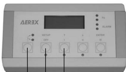
2. Drücken Sie die „I“ -Taste, die Anlage fährt mit den vorgegebenen Grundparametern an
