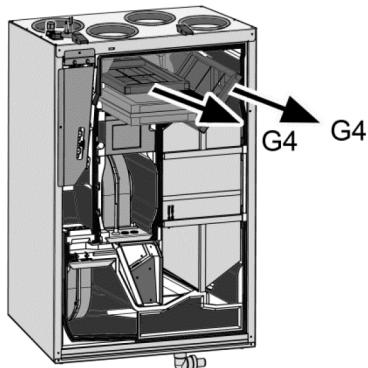
3. Ziehen Sie die Einschubrahmen der beiden G4-Luftfilter aus dem Lüftungsgerät.
