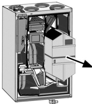
**ACHTUNG** **Beschädigung des Dichtstreifens, falls der Wärmetauscher verkantet herausgezogen oder eingeschoben wird.**
