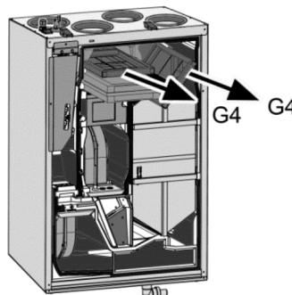
3. Retirez les cadres d'encastrement des deux filtres à air G4 de l'appareil de ventilation.
