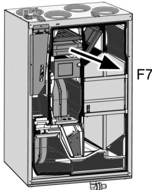
7. Ziehen Sie den F7-Pollenfilter aus dem Lüftungsgerät heraus.
