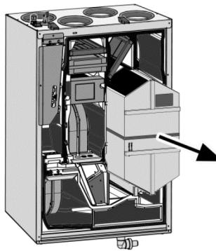
**ATTENTION Endommagement du cordon d'étanchéité si l'échangeur de chaleur est retiré ou inséré de travers.**
