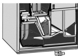
3. Entfernen Sie eventuell in der Kondensatwanne bzw. in der Ablaufleitung befindliche Ablagerungen. Spülen Sie die Leitung mit ausreichend Wasser durch.
