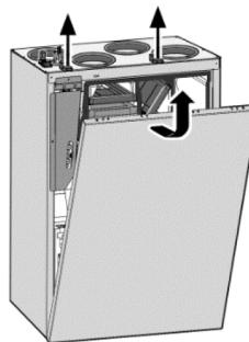
2. Desserrez les 2 fermetures de serrage rapide et retirez le cache de protection avant.
