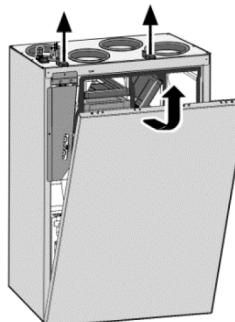
2. Lösen Sie die 2 Schnellspannverschlüsse und entfernen Sie die Frontabdeckung.
