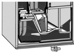
3. Retirez les dépôts éventuellement présents dans le bac à condensat ou dans la conduite d'écoulement. Rincez la conduite avec beaucoup d'eau.
