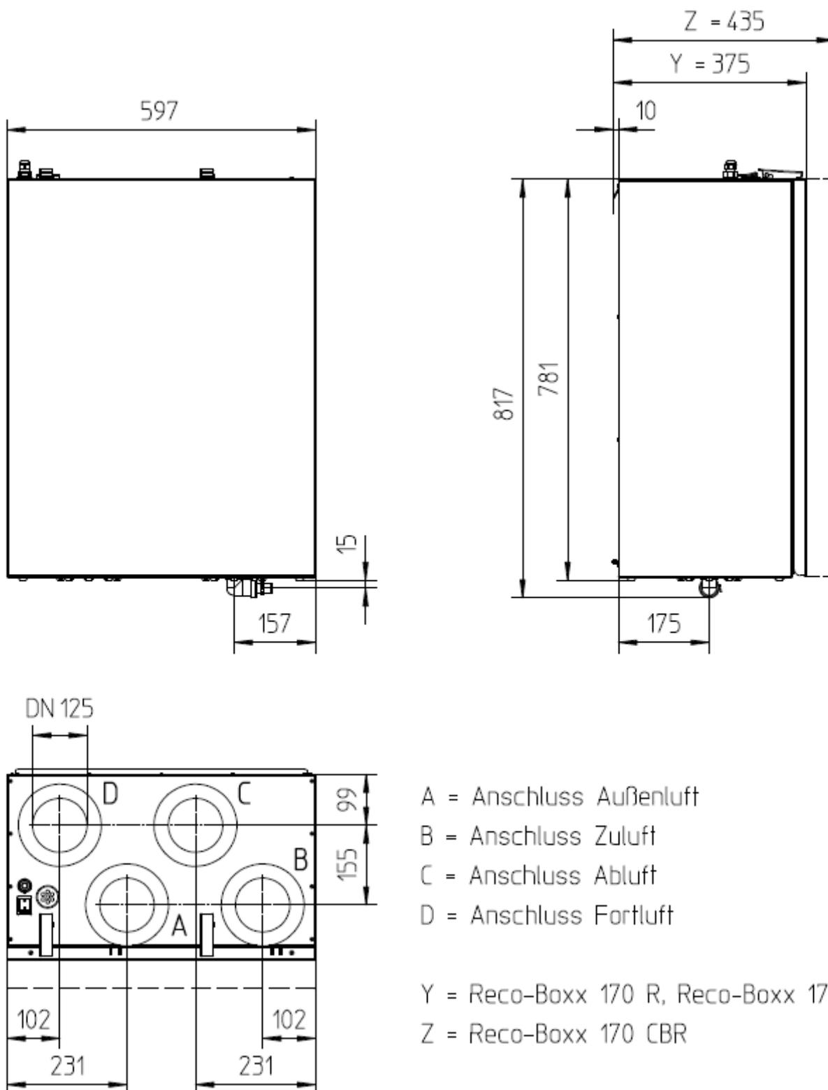
Zentrales Lüftungsgerät mit Wärmerückgewinnung vom Typ "Reco-Boxx 170"
