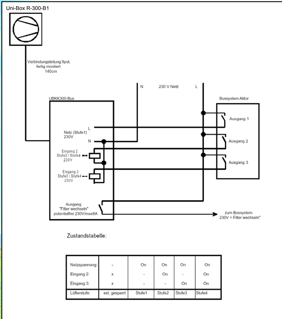
Uni-Box R-300-B1 incl. Klemmkasten UBKK300-Bus, vorbereitet zur Ansteuerung über ein beliebiges Bussystem mit bauseits zu stellendem Aktor. Die Uni-Box R-300 B1 besitzt zwei 230 V Eingänge um max. 4 unabhängige Volumenstromstufen vorzugeben.
