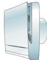
Schallgedämmter Außenwandluftdurchlass mit integrierter Sturmsicherung. Volumenstrom manuell stufenlos einstellbar über integrierte Irisblende, mit Standardfilter (G2). Pollenfilter (G3) optional erhältlich.
