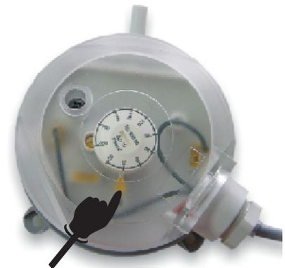
Voreingestellt ist ab Werk 0,5 mbar = 25 PA (siehe Abb). Verändern Sie diesen Wert etwas nach oben (z.B. ca. 40 Pa) und kontrollieren Sie nach ordnungsgemäßem Zusammenbau die Filterwechselanzeige. Die Anzeige sollte erloschen sein. Wenn nicht, Schritt 3.
