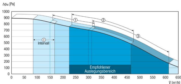
① Intervall-/Urlaubsbetrieb zum Feuchteschutz ② Reduzierte Lüftung ③ Nennlüftung ④ Intensiv-/Partybetrieb
