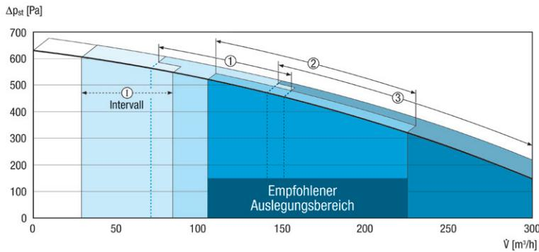
① Intervall-/Urlaubsbetrieb zum Feuchteschutz ② Reduzierte Lüftung ③ Intensiv-/Partybetrieb
