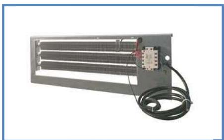
Ist in der Reco-Boxx ein elektrischer Vorerhitzer EV installiert, so ist die Wärmerückgewinnungseinheit gegen Einfrieren geschützt. Dabei wird die Leistung des Vorerhitzers so angepasst, dass eine vorgegebene Temperatur am Austritt der Wärmerückgewinnungseinheit auf der Fortluftseite nicht unterschritten wird.
