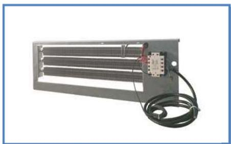
Das Elektro-Nachheizregister EN ermöglicht eine konstante Regelung der Zulufttemperatur und erhöht damit den Komfort. Das Elektro-Nachheizregister EN ist fertig verdrahtet mit einer Regelung in der Reco-Boxx integriert. Eine um rund 10 Kelvin erhöhte Zulufttemperatur gegenüber der Temperatur nach dem Luft-Wärmetauscher ist möglich.
