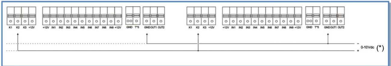
(\*) K2 ⇒ 0-10V Signal, maximal zulässige Impedanz: 1500 Ω
