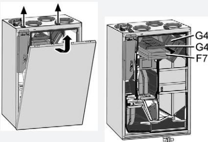
Desserrer les deux fermetures à serrage rapide et retirer le cache de protection.
