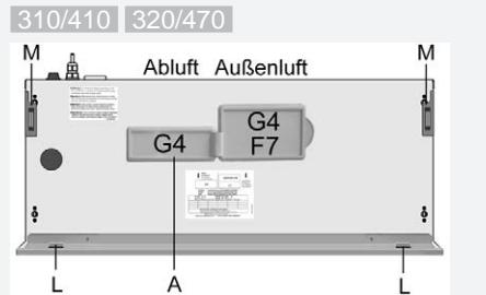
Frontblech an den beiden oberen Ecken nach vorne kippen (Magnete [M]) und nach oben abnehmen. Filterabdeckung entfernen.
