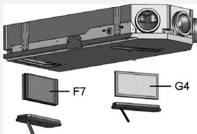
Filterabdeckung an den Schlaufen entnehmen.
