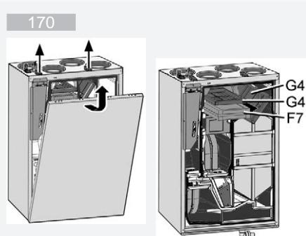
Die beiden Schnellspannverschlüsse lösen und die Frontabdeckung entfernen.
