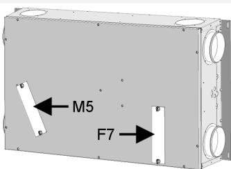
Bei **QD AR und QD AL-Geräten** die Haube entfernen (4 Schrauben).
