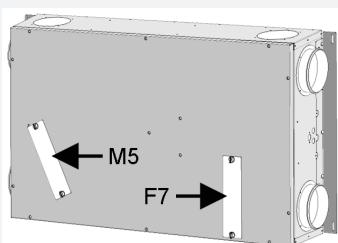
**Risque de blessure en cas de chute du capot (Trio QD AR et QD AL).** Veiller à une fixation irréprochable du capot. Fixer le capot avec les 4 vis.
