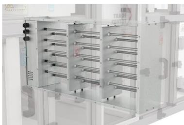
Das Elektro-Nachheizregister EH ermöglicht eine konstante Regelung der Zulufttemperatur und erhöht damit den Komfort. Das Elektro-Nachheizregister EN ist fertig verdrahtet mit einer Regelung in der Reco-Boxx integriert. Eine um rund 10 Kelvin erhöhte Zulufttemperatur gegenüber der Temperatur nach dem Luft-Wärmetauscher ist möglich.
