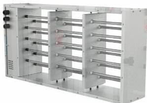
Ist im RLT-Gerät ein elektrischer Vorheizregister PH installiert, so ist die Wärmerückgewinnungseinheit gegen Einfrieren geschützt. Dabei wird die Leistung des Vorheizers so angepasst, dass eine vorgegebene Temperatur am Austritt der Wärmerückgewinnungseinheit auf der Fortluftseite nicht unterschritten wird.
