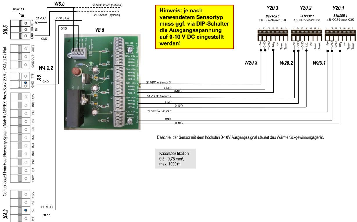
**Zu beachten: Es sind die technischen Spezifikationen des gewählten RLT-Gerätes zur Auswahl der Kabelspezifikation zugrunde zu legen. Diese Kabelzugliste ist nicht auf ein bestimmtes Gerät festgelegt! Schaltbild (Auszug).** Die Gesamtübersicht Schaltbilder ist beim Produkt zu finden unter: Downloads / Planung / Schaltbilder
