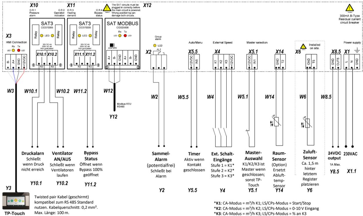
**Zu beachten: Es sind die technischen Spezifikationen des gewählten RLT-Gerätes zur Auswahl der Kabelspezifikation zugrunde zu legen. Diese Kabelzugliste ist nicht auf ein bestimmtes Gerät festgelegt! Schaltbild (Auszug).** Die Gesamtübersicht Schaltbilder ist beim Produkt zu finden unter: Downloads / Planung / Schaltbilder
