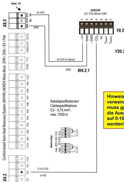
**Hinweis: je nach verwendetem Sensortyp muss ggf. via DIP-Schalter die Ausgangsspannung auf 0-10 V DC eingestellt werden!**
