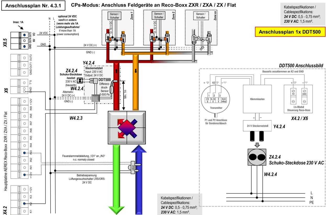
**Zu beachten:** Es sind die technischen Spezifikationen des gewählten RLT-Gerätes zur Auswahl der Kabelspezifikation zugrunde zu legen. Diese Kabelzugliste ist nicht auf ein bestimmtes Gerät festgelegt! **Schaltbild (Auszug).** Die Gesamtübersicht Schaltbilder ist beim Produkt zu finden unter: Downloads / Planung / Schaltbilder
