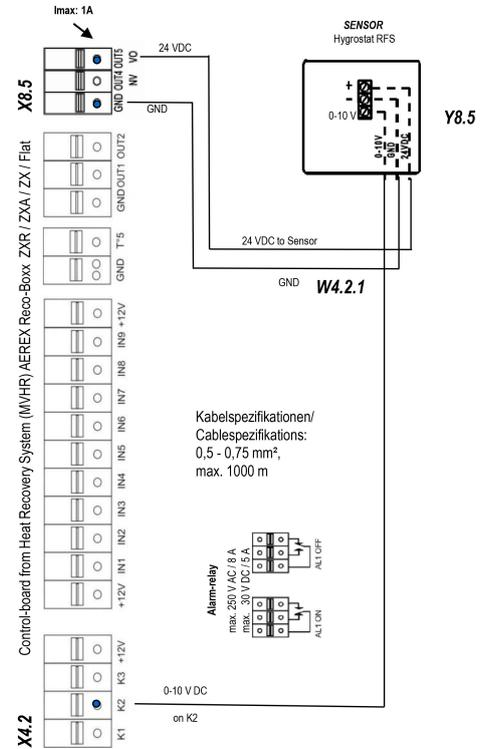
**Zu beachten: Es sind die technischen Spezifikationen des gewählten RLT-Gerätes zur Auswahl der Kabelspezifikation zugrunde zu legen. Diese Kabelzugliste ist nicht auf ein bestimmtes Gerät festgelegt! Schaltbild (Auszug).** Die Gesamtübersicht Schaltbilder ist beim Produkt zu finden unter: Downloads / Planung / Schaltbilder
