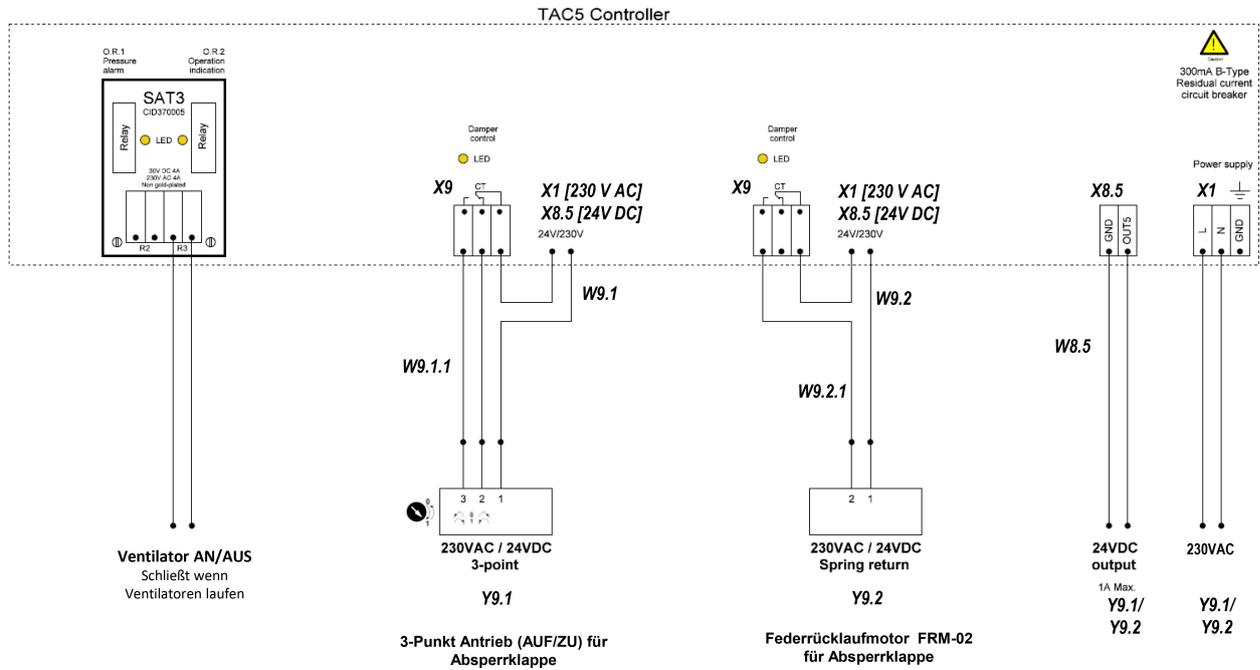
**Zu beachten: Es sind die technischen Spezifikationen des gewählten RLT-Gerätes zur Auswahl der Kabelspezifikation zugrunde zu legen. Diese Kabelzugliste ist nicht auf ein bestimmtes Gerät festgelegt! Schaltbild (Auszug).** Die Gesamtübersicht Schaltbilder ist beim Produkt zu finden unter: Downloads / Planung / Schaltbilder
