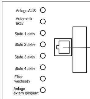
**Achtung! - Bedienteil und Klemmkasten lassen sich NUR über RJ45 - Stecker miteinander verbinden - keine Standard Telefonleitung möglich! - Modulkabel ggf. vorher gesondert bestellen.**
