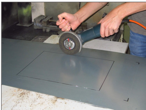
7. Nach Fertigstellung der beiden Ausschnitte die beiden lose mitgelieferten Wärmedämmungen entsprechend dem ausgeschnittenen Querschnitt anpassen und diese innen auf die lose Rückwand kleben.
