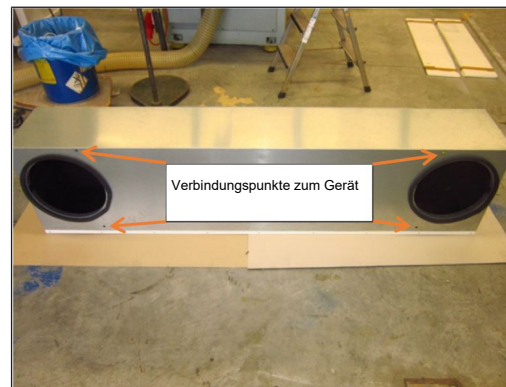
10. Anschlusskasten mit den 4 mitgelieferten Schrauben M8 x 25 mm fest mit dem Gerät verschrauben.
