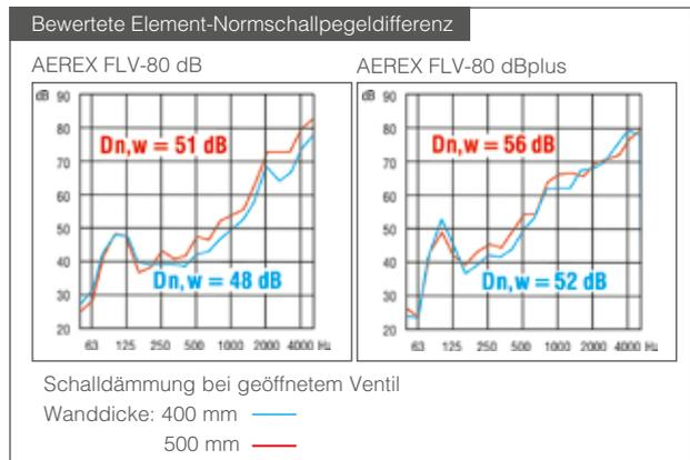
Schalldämmung bei geöffnetem Ventil
