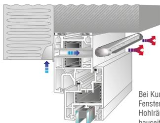
Bei Kunststofffenstern sowie vergleichbaren Fensterprofilen mit "Hohlkammern" sind die Hohlräume auf beiden Seiten des Luftkanals bauseitig abzudichten. Der Luftkanal ist von außen in den Fensterrahmen einzuschieben. Die Außengitter sind mit witterungsbeständiger Versiegelungsmasse wasserdicht am Profil abzudichten.
