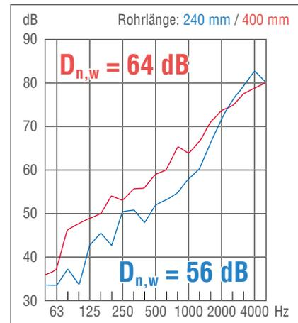
\*\* Bewertete Element-Normschallpegeldifferenz  $D_{n,w}$  nach DIN EN ISO 140-10 \*\*\* Schalldämmwert nach DIN 4109
