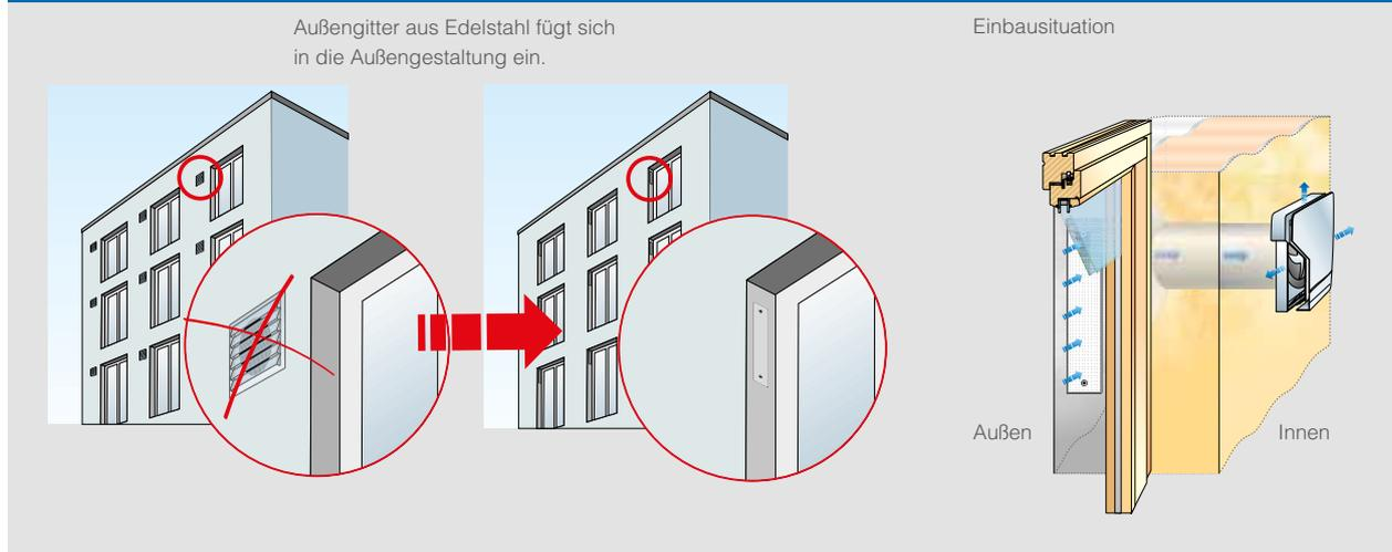
Das Fensterlaibungsgitter ist auf der Fassadenansicht des Hauses fast nicht sichtbar. Das Edelstahlgitter ist mit zwei Inbus-Schrauben am Installationsrahmen befestigt und zur Inspektion und Reinigung leicht abnehmbar.
